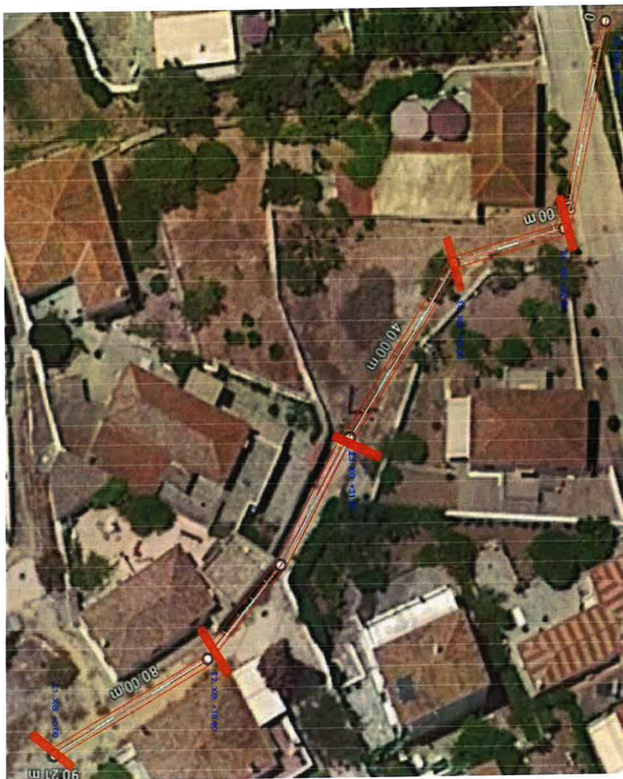
Εικόνα 3: Όδευση σωληνωτών και τοποθέτηση καναλιού ομβρίων
